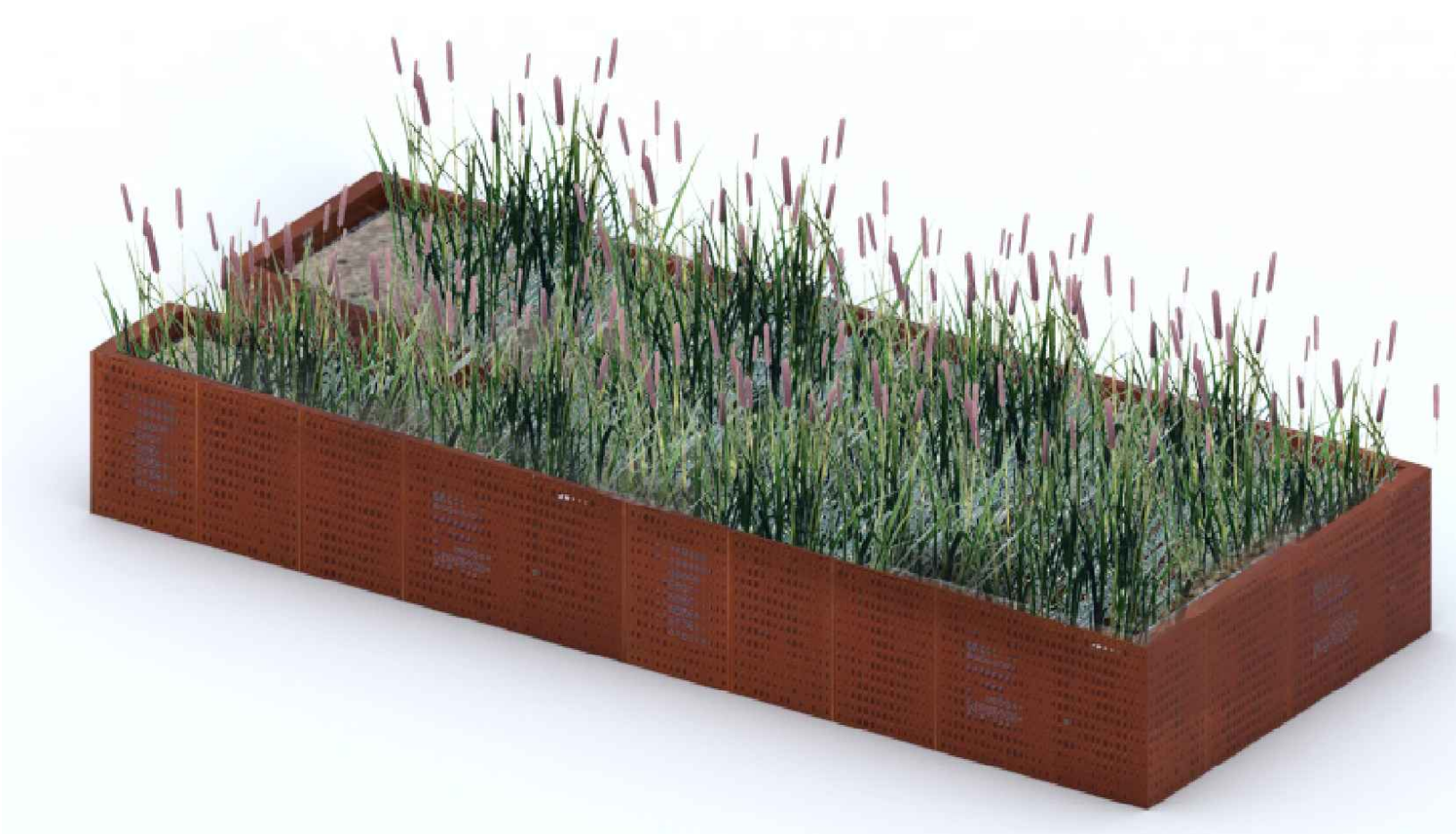
Imagen representativa de zona 2 humedal flujo vertical aireado
